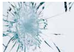
Das Verbund-Sicherheitsglas bricht trotz Gewalteinwirkung nicht auseinander.
