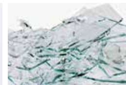
Gewöhnliches Fensterglas zersplittert und der Weg durch das Fenster ist frei.
